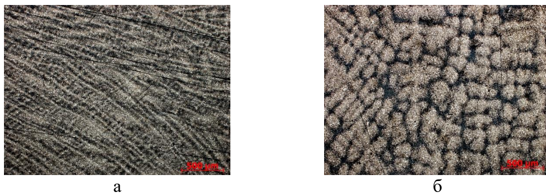
Рис. 1. Дендритна структура дослідних зливків зі сталі марки EA1N з різним співвідношенням вмісту Mn та Si: а – співвідношення Mn/Si=1,64, б – співвідношення Mn/Si=4,32
