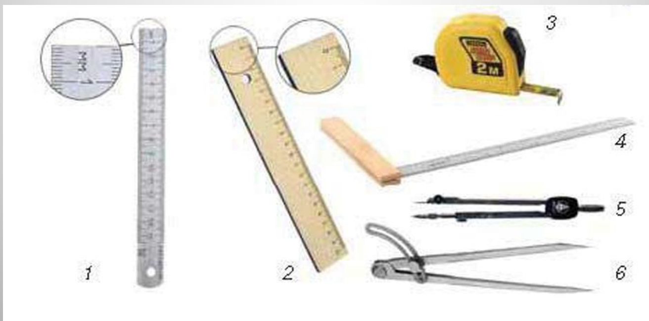
Мал. 29. Вимірювальні та розмічальні інструменти: 1 — металева (слюсарна) лінійка; 2 — дерев'яна лінійка; 3 — рулетка; 4 — кутник; 5 — креслярський циркуль; 6 — розмічальний циркуль
