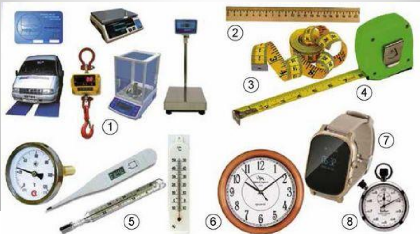
Мал. 8. Вимірювальні прилади: 1 – різні види терезів; 2 – лінійка; 3 – метр; 4 – рулетка; 5 – різні види термометрів; 6,7 – годинники; 8 – секундомір
