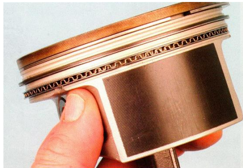
Рисунок 1 – Тонкий шар антифрикційного покриття (темного кольору) на спідниці поршня допомагає утримувати масло і знижує тертя між поршнем і циліндром - особливо при холодному запуску двигуна [5]
