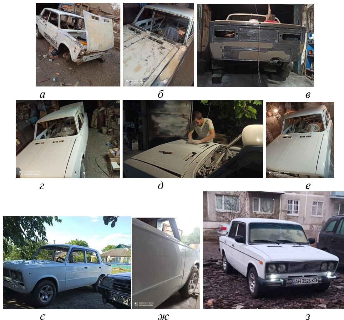
Рисунок 1 – Кузовні роботи з видалення корозії на ВАЗ 2106 (а). Шпаклювання елементів кузова ВАЗ 2106 (б, в). Ґрунтування ВАЗ 2106 (г). Замивання ґрунту на ВАЗ 2106 (д). Повне фарбування кузова ВАЗ 2106 (е, є). Полірування кузова ВАЗ 2106 (ж). Готовий результат після ремонту автомобіля ВАЗ 2106 (з)
